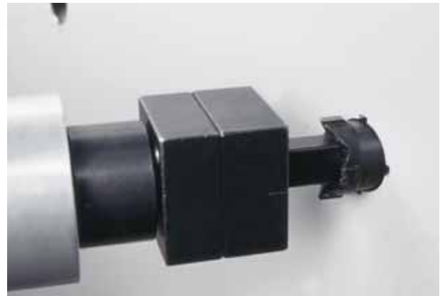
Greenlee delme aletleri farklı şekil ve büyüklüklerdeki delme işlemlerini kolaylaştırır.
